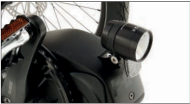
Die motorisierten Special Edition -Modelle statten wir mit der IQ-X /Akku-Lichtanlage von Busch&Müller aus (Scheinwerfer bis zu 150 Lux, Rücklicht B&M Toplight 2C DC). Das An- und Ausschalten fällt leicht dank einer optisch hervorgehobenen Taste.
