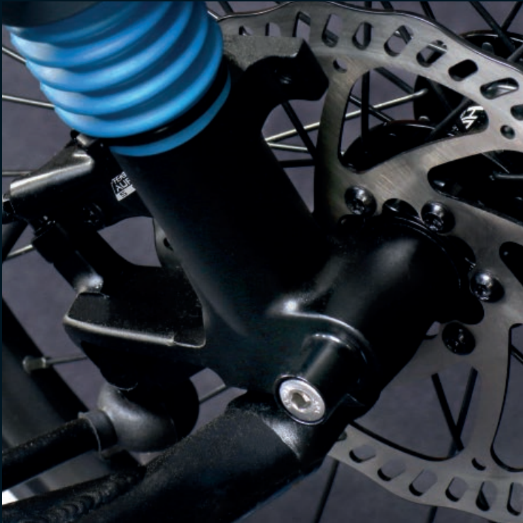
Leichter Aluminium-Radträger mit Faltenbalg am Federbein. Oberfläche gestrahlt und schwarz matt eloxiert. Dichtungsmanschette über dem äußeren Kugelkopf der Spurstange im Spritzwasserbereich der Räder.
