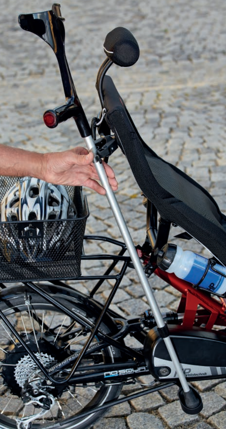
Einfaches Einsetzen, sicheres Mitführen und schnelle Entnahme: Der Gehhilfenhalter mit praktischer Schnellaufnahme passt sich stufenlos auf Durchmesser von 20 bis 30 mm an. HP VELOTECHNIKS Fixierung aus Federstahl sorgt für sicheren Halt und gibt die Gehhilfe dank Einhandbedienung schnell und einfach frei.
