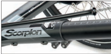
Der Rahmen wird auf Ihre Beinlänge durch Einschieben oder Ausziehen des Tretlagerauslegers eingestellt.
